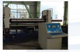
HYDRAULIC ROLLING MACHINE 2500MM X 32MM THK
